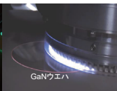
プラズマ援用研磨: プラズマ改質と軟質固定砥粒研磨により高効率ダメージフリー研磨を実現
