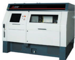
三菱電機社製50W 266nmレーザー加工機
