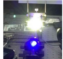
高出力青色レーザー光による発光
