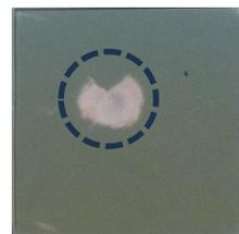
Fig. 7 金属ナノ粒子担持ポリマー表面へのXUV照射により、界面創生が示された。
