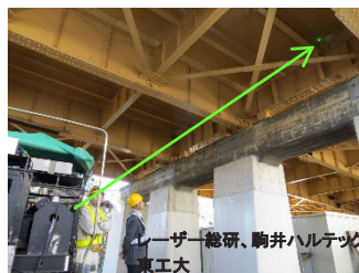
図. 装置からレーザーを照射して鋼板の浮きを検査
