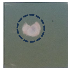
Fig. 7 金属ナノ粒子担持ポリマー表面へのXUV光照射により、界面創生が示された。
