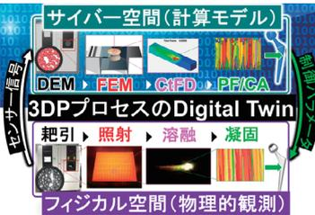
原子レベルからメートルレベルにおける構造と特性の関係を解明し、環境に配慮して有用な性能を持つ材料を設計し、その製造プロセスを創製する研究を進めています。特に、計算機シミュレーションと実験の融合、データ駆動型のアプローチによる材料プロセスの最適化を、レーザによる3Dプリンターで発生する特殊な環境（超温度場）における特異な凝固・結晶成長現象の解明と制御に焦点を当てて研究をしています。さらに、希少元素フリーで高機能を発現する力学メタマテリアルの開発や、リサイクルによる持続可能社会の実現に開発に貢献する研究も行っています。
