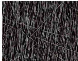
ε-カプロラクトン(PCL)より作成した ナノファイバー・スキャフォールド 電子顕微鏡像
