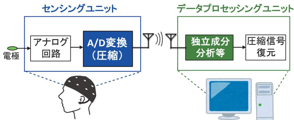
圧縮センシングを用いると、信号を圧縮しながらサンプリングを行い、回路で扱う情報量を削減出来るため、「回路の低消費電力化」が可能になる。これは搭載バッテリーサイズの小型化や長時間動作に繋がる。ただし、一般的な圧縮センシング手法では、外乱混入に脆弱であり復元精度が悪化する等の課題に悩まされてきた。
