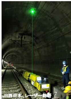
図. レーザー検査法
