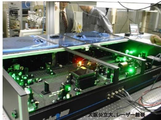
図. 波長 $2\mu\text{m}$ 帯フェムト秒レーザー装置
