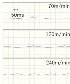
非磁性導電性材料における損傷評価。キズや欠陥等に由来する相互インダクタンスの変化に伴う誘導電流による磁場を高速・非破壊で観察することにより、材料表面・内部に存在する欠陥の高速検出が可能。図は高速回転するAl円盤表面の傷のレーザー磁気光学検出。
