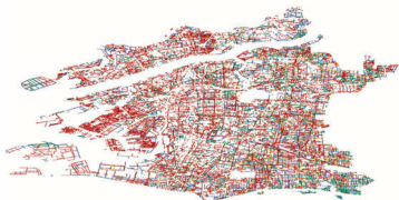
都市全体の下水道管の劣化予測シミュレーション（2050年度）
