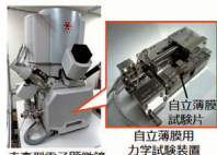
電子顕微鏡その場ナノ観察下力学試験システム
