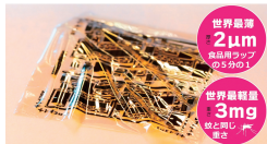
図1 フレキシブル有機薄膜電子回路技術を活用した生体計測回路
