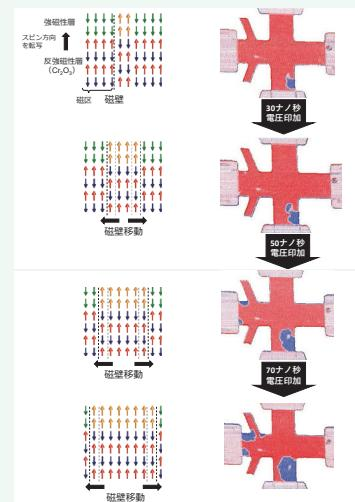
マイクロサイズのデバイスにおいて反強磁性スピンが反転する様子
