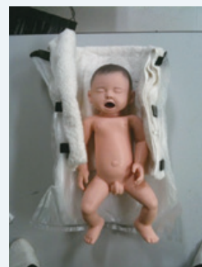
乳児人形 : K タオル : 4と共に変形 白い物体 : 4を加熱&冷却により変形&固化
